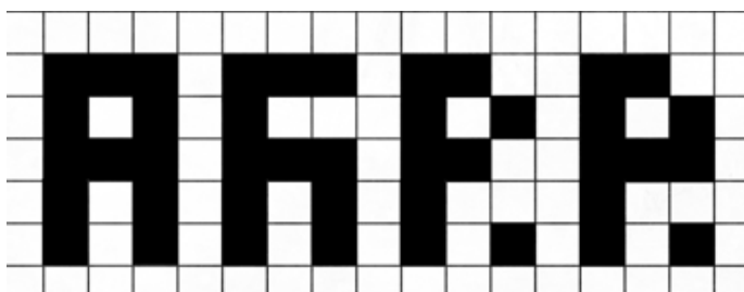
рис. 15. Тестовая выборка. Варианты искаженной буквы А
